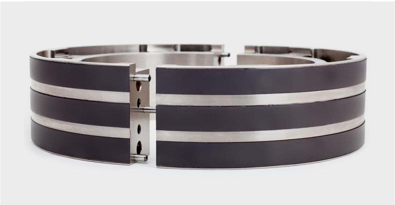
Две половины магнитных колец соединяются винтами, надежно зажимаются на валу, крепятся к выступу на валу или отдельному центрирующему кольцу. Hübner предлагает сплит-систему MAG с запатентованной конструкцией с положительной посадкой для применений, работающих на особенно высоких скоростях.
