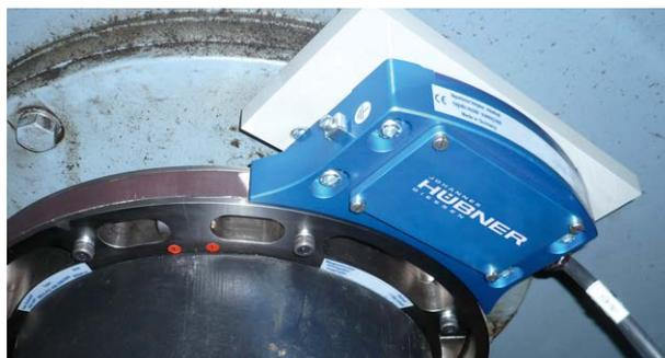
Решение с разъемным магнитным кольцом без демонтажа установки /
